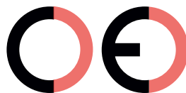
Falsche CE-Kennzeichnung (zu großer Zwischenraum)
