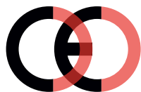
Falsche CE-Kennzeichnung (zu dicht)
